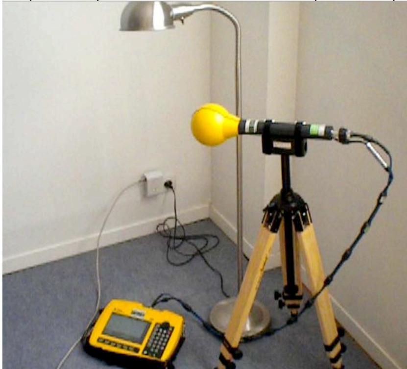
Tant que le boîtier CPL n'est pas raccordé : aucun signal visible entre 2 et 22 MHz. Lorsque le boîtier CPL est raccordé, un signal pulsé est présent. Lorsque le fil d'alimentation électrique de la lampe est raccordé, ce signal augmente transformant la lampe en antenne radio.
